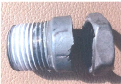
Приклад зламаного газового з'єднувального штуцера
