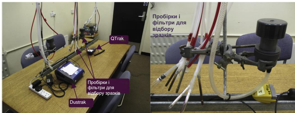
Малюнок 3. Місцезнаходження решітки і пробірок для відбору зразків у випробувальному приміщенні. Аерозольний монітор DustTrak і монітор якості повітря Q-Trak, TSI Inc., Шорв'ю, Міннесота, США.
